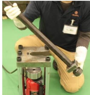
⑥油圧ジャッキのリリーフバルブを静かに開いてシリンダを元の位置まで戻し、管アセンブリを取り外す。
